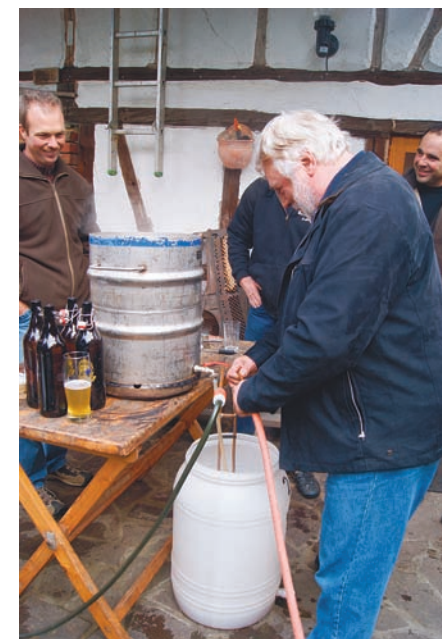
Die selbstgebaute Kühlspirale kühlt die Maische auf 20° C herunter; Freunde, Helfer und Verkoster sind schon längst anwesend. Dann heißt es sechs Wochen warten. Aber zum Glück ist noch genug Bier vom vorherigen Braugang übrig.
