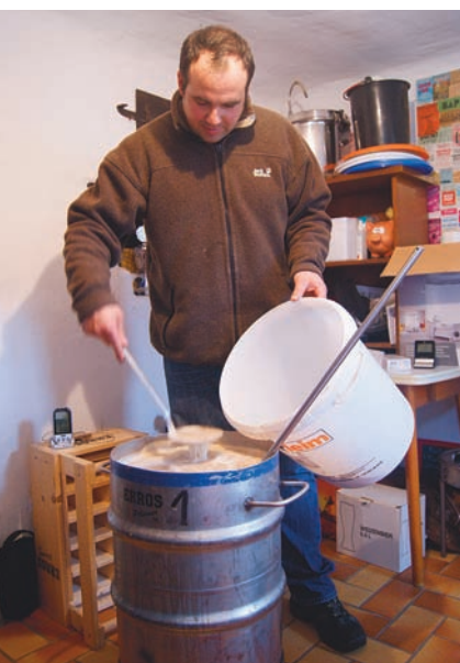
Eric erhitzt die Maische in verschiedenen Temperaturstufen und filtert Trubstoffe heraus. Roman leutert, danach füllen beide den Nachguss auf.
